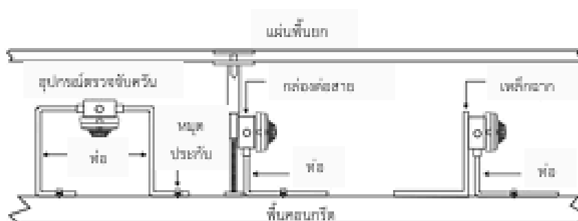
รูปที่ 6.6 ลักษณะการติดตั้งอุปกรณ์ตรวจจับควันชนิดจุดใต้พื้นยกกระดาน
