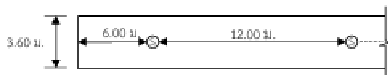
รูปที่ 6.3 ตำแหน่งติดตั้งอุปกรณ์ตรวจจับคว้นสำหรับพื้นที่ช่องทางเดิน
